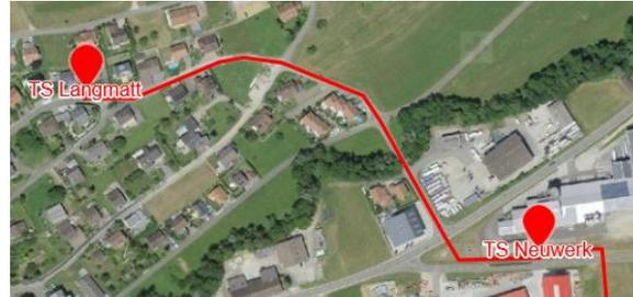
Die Haupteinspeisung von Wittnau wurde von der Freileitung zurückgebaut und wird nun direkt von der TS Neuwerk versorgt. Dieser Abgang ist mit einem Schutz versehen, um bei einem Fehlerfall nur das betroffene Segment auszuschalten.
