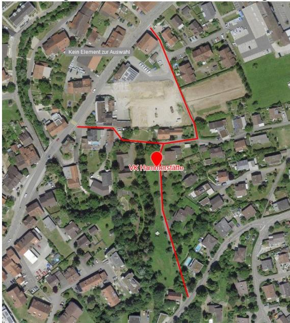
Aufgrund der grossen Bautätigkeit am Hammerstätteweg und der Hammerstätte würde in diesem Gebiet eine neue Verteilkabine aufgestellt. In der Strasse wurden Rohrblöcke, für die noch unbebauten Parzellen, verlegt.
