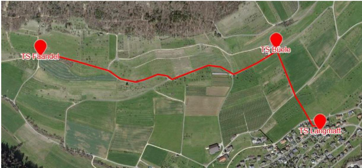
Bei der Sanierung der TS Büele und der TS Faandel wurde der Transformator, die MS- und NS-Verteilung ersetzt. Die Zuleitungen wurden mit einem 95mm<sup>2</sup> Alu-Kabel erneuert.
